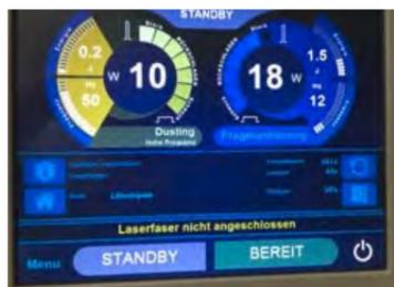
Abb 2b: Frequenz, Amplitude und Impulsdauer sind unabhängig voneinander einstellbar.
