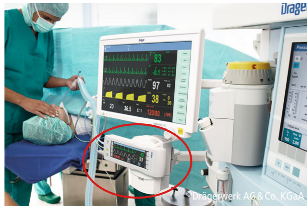
Abb.: Der auf dem Transportweg verwendete Infinity M540 Monitor (siehe rote Markierung) bildet nicht nur aktuelle Kurven und Werte ab, sondern speichert auch die Vitaldaten lückenlos. Wird der kompakte tragbare Monitor an eine Docking Station angeschlossen, überträgt er alle Werte, Verläufe und die Patientenhistorie automatisch auf einen großen Touchscreen-Bildschirm.
